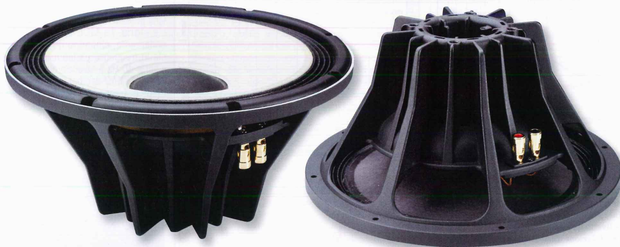
Il woofer da dodici pollici è un concentrato di tecnologie per ridurre al minimo le non linearità a bassa frequenza. I due magneti anulari in neodimio e le due bobine mobili presentano un campo estremamente regolare anche per notevoli spostamenti dell'equipaggio mobile.
