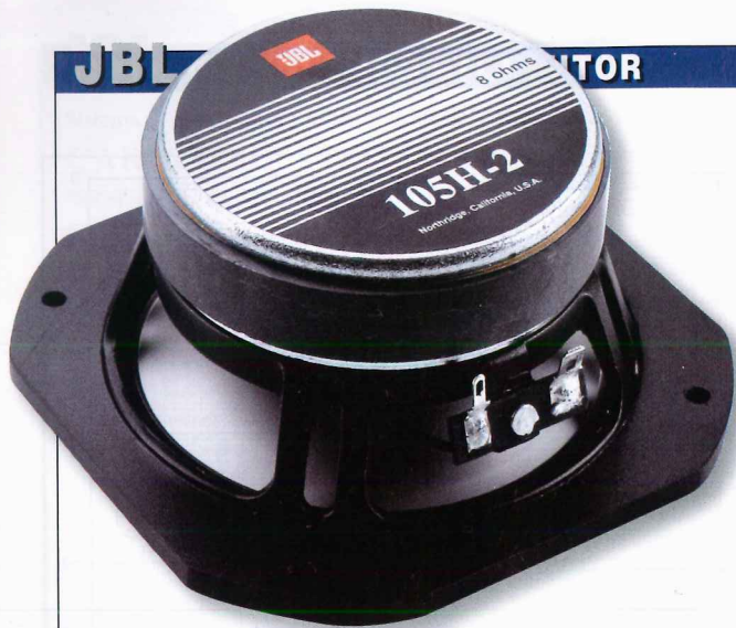
Il midrange da 125 millimetri di diametro nominale è dotato di una cupola rovesciata costituita da una lega di magnesio ed alluminio. Notate il complesso magnetico dovuto ad un generoso anello di ferrite.
