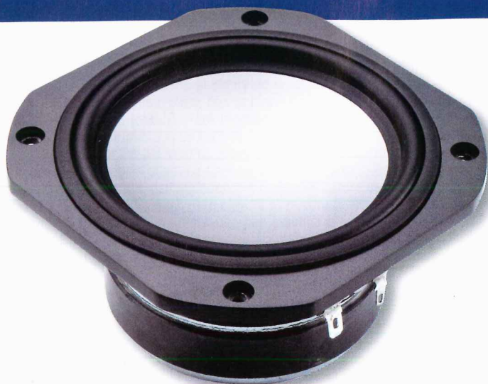
Il midrange da 125 millimetri di diametro nominale è dotato di una cupola rovesciata costituita da una lega di magnesio ed alluminio. Notate il complesso magnetico dovuto ad un generoso anello di ferrite.
