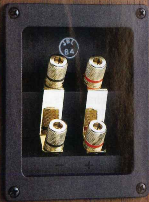
I quattro connettori di ingresso sono sistemati su una vaschetta plastica e ponticellati per consentire il monocablaggio.
